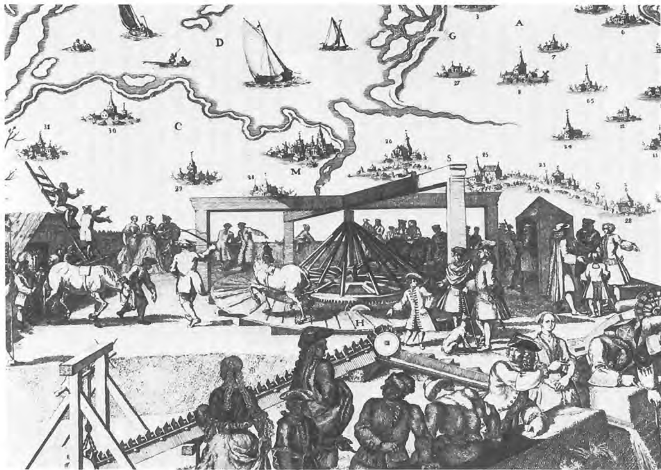
Een door paarden aangedreven z.g. kettingmolen anno 1740. Dergelijke molens werden ook bij de vestingbouw gebruikt. (Prentenkabinet Prov. Genootschap van K & W in Noord-Brabant.)
