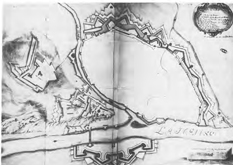
1. Plan van de Stad Namen (zie ook vorige Jaarboek blz. 123). Projecten van 1690-1691. A. Willem's fort (Fort Guillaume of 'Fort de la Mère de Dieu'). B. Bruggehoofd van Jambes.
